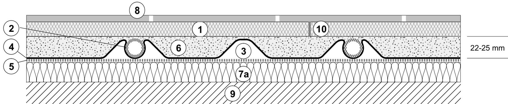
schwimmende Verlegung auf Dämmung gegen beheizt
